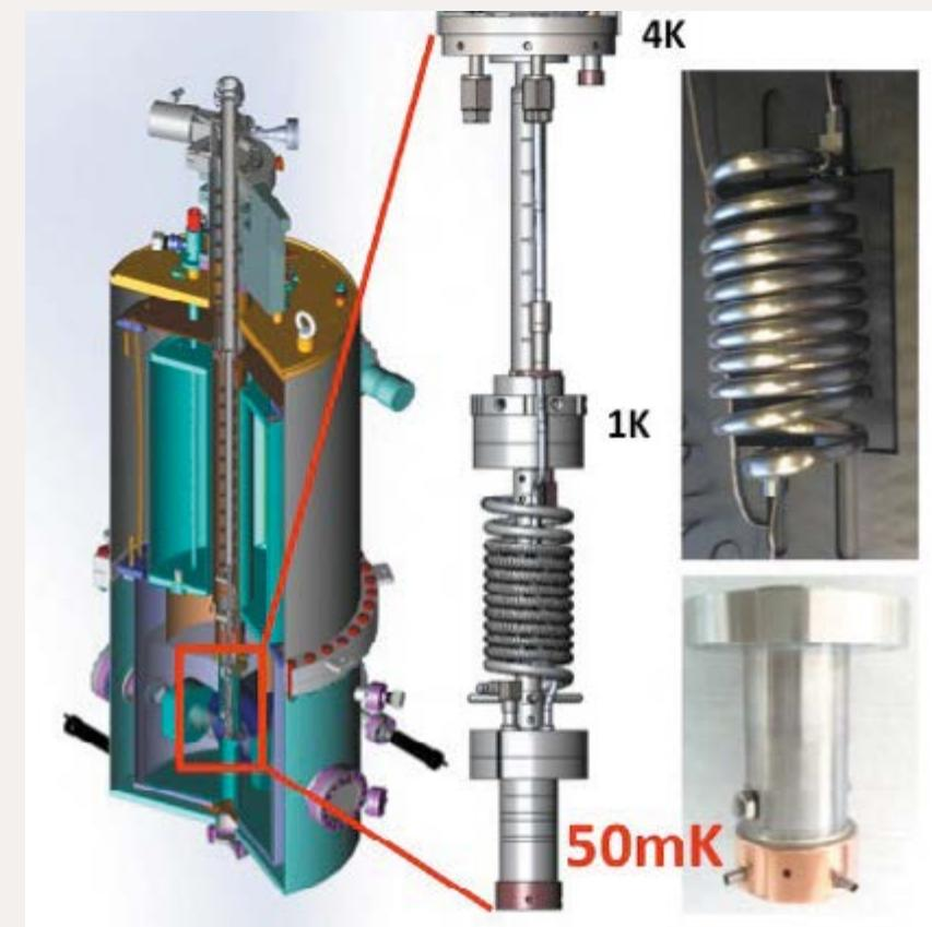
Figure 1 - à gauche : vue 3D d'une coupe du cryostat 7 teslas de DEIMOS, détails des derniers étages froids de la dilution ; à droite : photos des composants en cours de montage (avec l'aimable autorisation de Cryoconcept).
