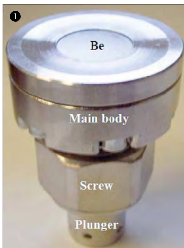
Figure 1 : la cellule électrochimique conçue pour les expériences operando
