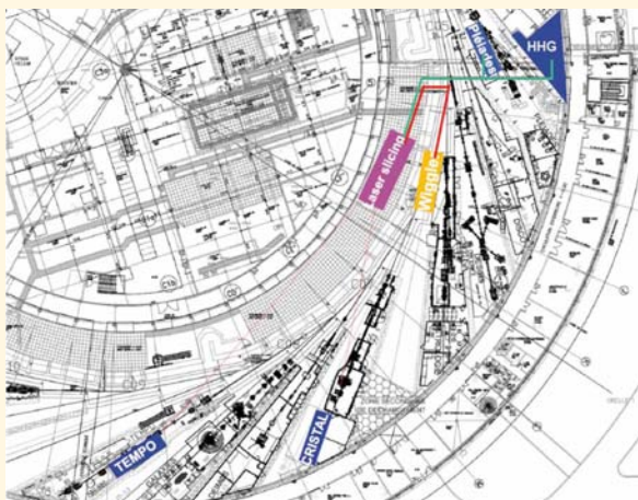
Figure 2 : localisation de la cabane laser slicing, du wiggler modulateur et des lignes de lumière impliquées.
