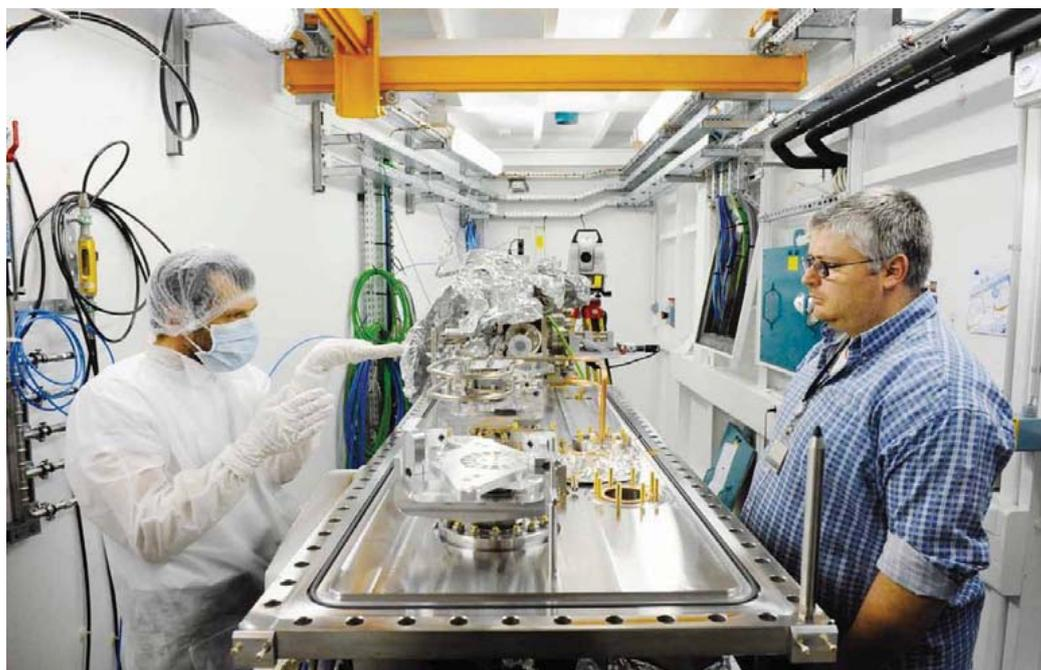
Dans la cabine optique de DEIMOS, mise en place d'un miroir.
