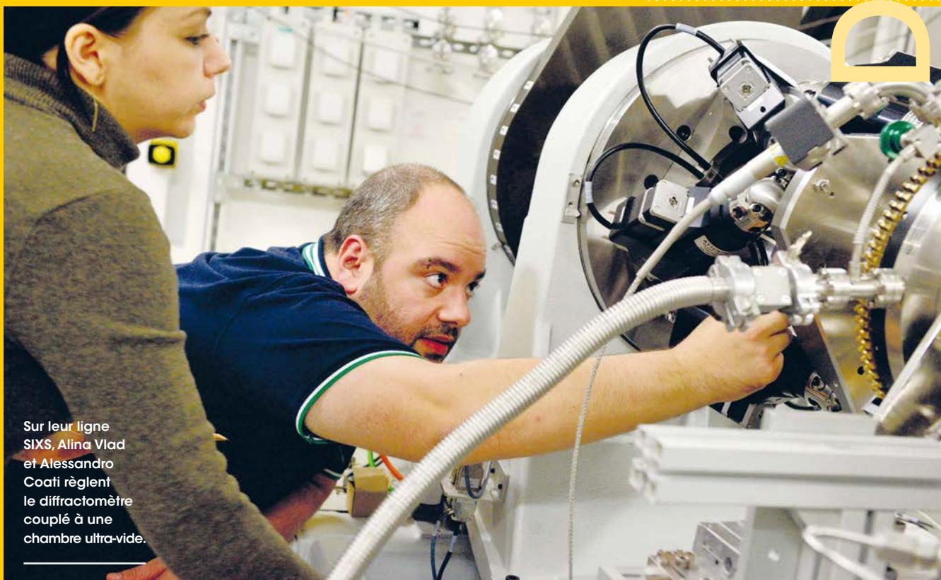
Sur leur ligne SIXS, Alina Vlad et Alessandro Coati règlent le diffractomètre couplé à une chambre ultra-vide.
