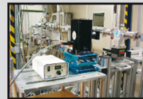
Montage à 80K (-193°C) pour mesures de transfert d'électrons induit par la lumière bleue (475 nm) (Ligne de lumière XAFS - synchrotron Elettra, Italie).
