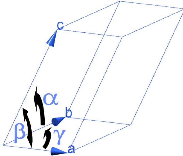
Il existe 7 systèmes de base en fonction des différentes possibilités  $a, b, c, \alpha, \beta, \gamma$
