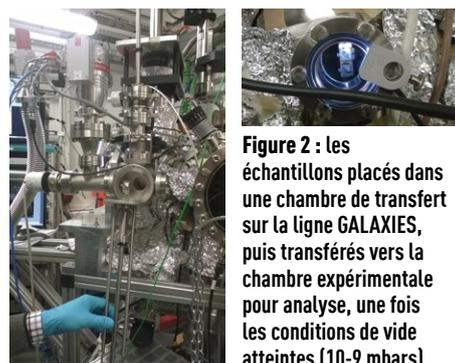
Figure 2 : les échantillons placés dans une chambre de transfert sur la ligne GALAXIES, puis transférés vers la chambre expérimentale pour analyse, une fois les conditions de vide atteintes (10<sup>-9</sup> mbars).
