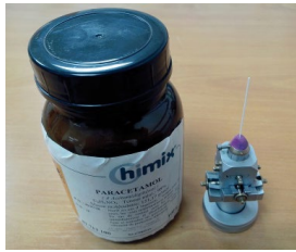
Figure 2 : Echantillon de paracétamol introduit dans un capillaire de 0,7mm monté sur une tête goniométrique.
