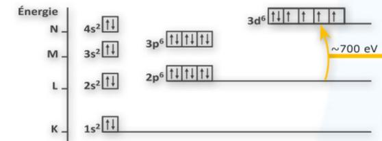
Éclairé par les photons X de 700 eV, l'échantillon de fer "réagit" : les électrons de cœur sont excités et montent vers les états inoccupés responsables du magnétisme. Dans son langage, le chercheur "sonde la couche 3d à partir du niveau 2p".
