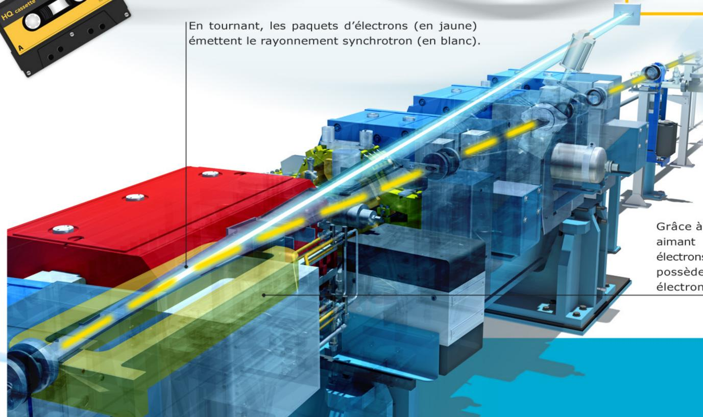
Grâce à son champ magnétique de 1,71 tesla, cet aimant de courbure, ou dipôle, fait tourner les électrons de 11°25'. Le synchrotron SOLEIL possède 32 dipôles qui bouclent la trajectoire des électrons, formant ainsi un "anneau de stockage".
